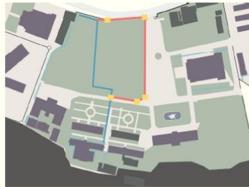
改善後溝渠(示意圖)，新設陰溝及陰井。
