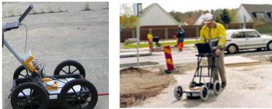
圖3-1 MALA GeoScience透地雷達檢測設備及系統構成
